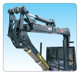
Гидравлические шланги и трубки имеют двойное крепление. Сварные швы находятся в зонах, не подверженных нагрузкам. Широкое угловое соединение позволяет удобно двигаться на рабочем участке.
