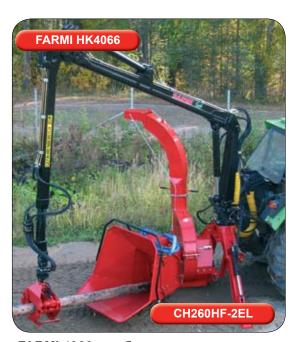
FARMI 4066 и рубительная установка СН260HF вместе на тракторе при помощи 3-точечного соединения
